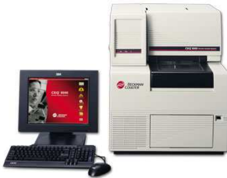
Sistemul de analiză genică Beckman Coulter CEQ8000, folosit pentru secvențiere genică și analiză de fragmente ADN prin electroforeză capilară
