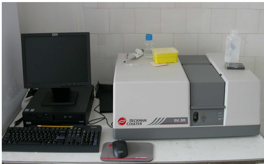
Spectrofotometrie UV/Vis pentru cuantificarea acizilor nucleici
